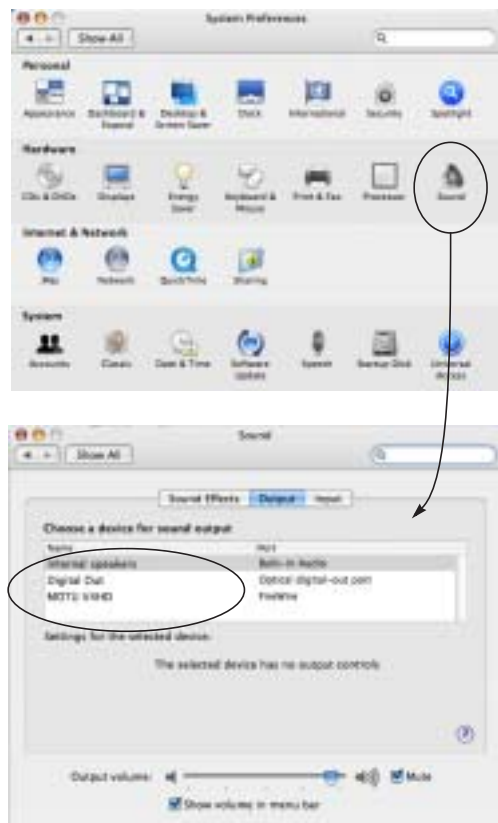
図 8-2: システム環境設定ウインドウのサウンドでは、V4HD を Macintosh のシステムサウンドインプット/アウトプットに指定することができます。
