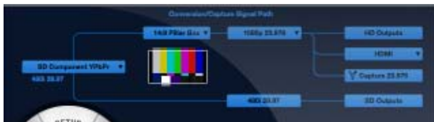
図 11-1: スタンドアローンハードウェアコンバージョンと分配の例。
