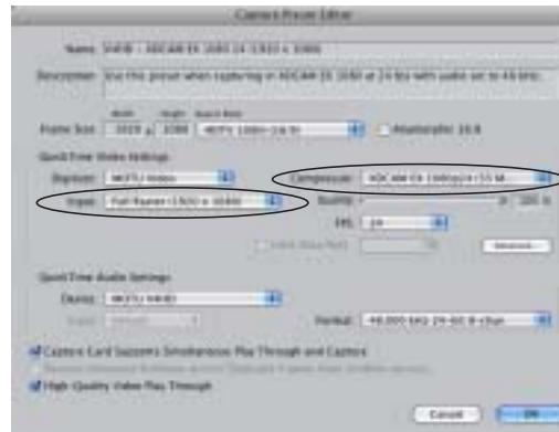
図 7-4: HD コーデックの設定。インプットメニューで“Full Raster (1920 x 1080)”，または“Full Raster (1280 x 720)”が選択されていることを確認します。
