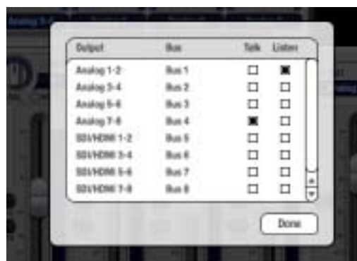
図 9-4: トークバック / リッスンバックシグナルをアウトプットへルーティング。
