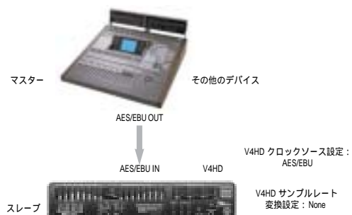
図 3-18: V4HD を AES/EBU デバイスにスレーブ。V4HD のクロックソースは「AES/EBU」になります。
