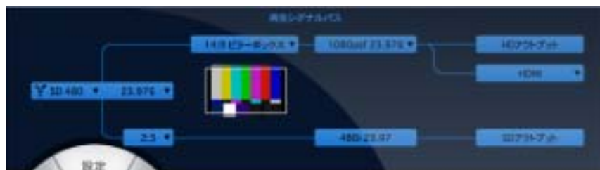
図 7-7: 再生時のハードウェア変換設定例。Final Cut Pro の 480p23.976 再生を、2:3 ブルダウンを追加して SD アウトプットから、1080p23.976 に変換して 14:9 ビラーボックスフォーマットを HD アウトプットから出力します。
