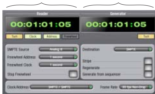
図 10-1: SMPTE Setup ソフトウェアでは、V4HD のオンボード SMPTE タイムコードシンクロナイゼーション機能を供給します。
