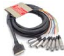
図 3-7: 8 チャンネル AES/EBU インプット / アウトプット用 DB25 トゥ XLR ブレイクアウトケーブル。（別売）AES/EBU では、4 つの XLR（メス）と 4 つの XLR（オス）コネクタを使用します。詳しい説明は、付録 D 「DB25 トゥ XLR ピンアウト」: 101 頁をお読みください。
