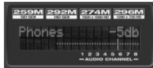
図 12-4: ノブを操作すると、設定中のパラメータを一時的に表示します。
