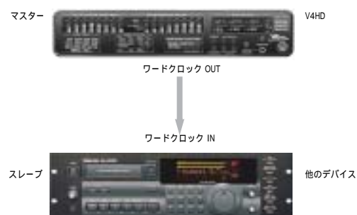
図 3-12: その他のデジタルオーディオデバイスをワードクロック経由で V4HD ヘスレーブ。V4HD の“ Clock Source ”設定で“ Video Clock ”を選択します。V4HD がオーディオオンリーモードの場合には、ワードクロック以外を選択します。
