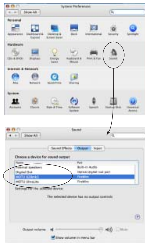
図 8-3: Mac OS X のサウンド設定。（環境設定内）この例では、828mk3 をシステムアウトプットに選択しています。
