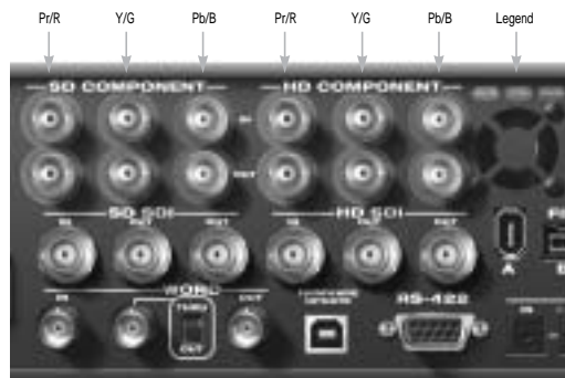
図 3-3: V4HD は “ RGB ” と “ YPbPr ” コンポーネントビデオの両方に対応しています。
