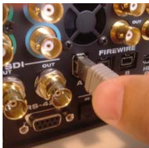
図 3-1: V4HD とコンピュータを接続。
