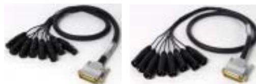
図 3-6: DB25 トゥ XLR ブレイクアウトケーブル。（別売）左はインプット用 8 つの XLR（メス）コネクタ DB25（オス）コネクタのブレイクアウトケーブル。右はアウトプット用 8 つの XLR（オス）コネクタ DB25（メス）コネクタのブレイクアウトケーブル。詳しい説明は、付録 D「DB25 トゥ XLR ピンアウト」：101 頁をお読みください。
