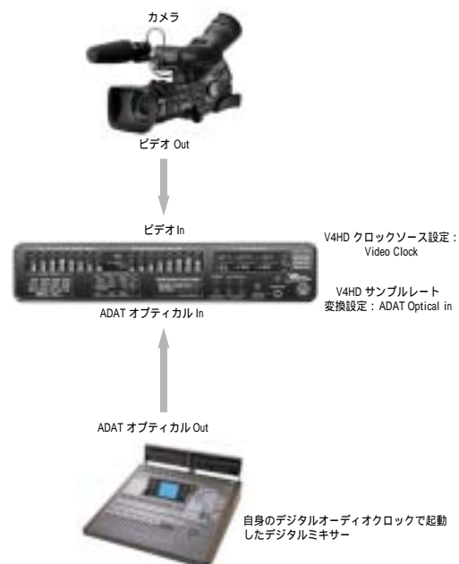
図 3-22: V4HD に同期していないデバイスからデジタルオーディオを取り込み。この例では、サンプルレート変換を使用しています。
